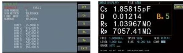
선택한 측정 매개변수 중 하나에 대한 BIN 설정은 최대 9개의 BIN 위치를 제공합니다. 원하는 BIN 방법 (EQUAL/SEQUENTIAL/TOLERANCE/RANDOM) 및 한계값 모드(VALUE/delta/delta%)에 따라 개별 분류에 대한 판단 기준을 설정합니다.
