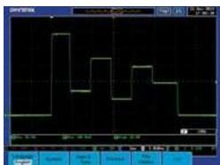
시퀀스 기능을 실행할 때 PEL-3000AE 시리즈는 단계 1, 단계 2, 단계 3 등의 시간 및 부하 설정을 따라 다양한 부하 전류 변화를 실현합니다.
