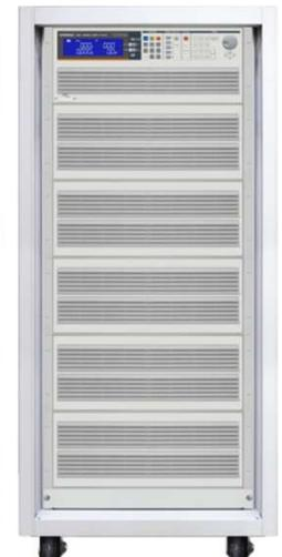
AEL-5000시리즈 AC/DC 전자 부하는 전력 범위에 따라 20개 모델이 있습니다. 단일 장치의 전력 범위는 1,875~22,500W이며 최대 8개 장치를 병렬로 연결할 수 있습니다. 단상 병렬 연결시의 최대 전력은 180kW이며 3상 총 전력은 540kW까지 확장이 가능합니다. 이는 UPS, 인버터/차단기, AC 전원, 배터리, 퓨즈/차단기, DC 전원 및 기타 응용 프로그램에 적합합니다.
