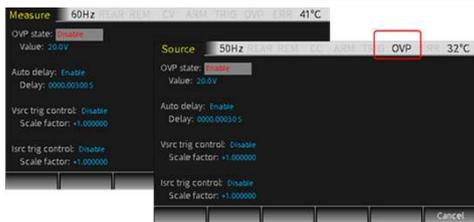
GSM-20H10은 OVP/OTP 보호 모드를 제공합니다. 사용자는 OVP의 범위를 정의할 수 있으며 OTP 보호는 테스트 과정에서 온도 드리프트로 인한 오류를 효과적으로 방지할 수 있습니다.
