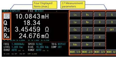
LCR-8200(A) 시리즈는 사용자가 측정 매개변수를 선택하고 정렬할 수 있도록 합니다. 사용자는 17개의 측정 매개변수 중에서 최소 하나에서 최대 네 개의 매개변수를 선택할 수 있으며 측정 요구에 따라 표시 순서도 원하는 대로 정렬할 수 있습니다.
