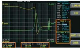
DUT의 최대 2개의 특성 매개변수를 동시에 스위핑할 수 있습니다. 스위핑 유형(주파수/Vac/Iac), 축 형태(LOG/LINEAR), 스위핑 속도, 심지어 바이어스(내부)를 실제 요구에 따라 설정할 수 있습니다. 스위핑이 완료되면 자동 조절을 사용하여 최적의 관측 표시를 얻을 수 있습니다.
