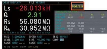
선택한 각 테스트 매개변수는 독립적으로 값, 차이 값 또는 차이 비율과 같은 판단 및 비교를 설정할 수 있습니다. 또한 표시 방법은 값, 차이 값 또는 차이 비율에 따라 테스트 결과의 표시를 자체 정의할 수 있으며, 이로써 실제 요구에 더 부합하는 관측이 가능합니다.
