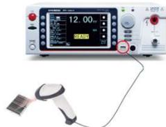
GPT-15012는 바코드 기계의 연결 메커니즘을 지원합니다. 사용자는 바코드 기계의 사용 및 설정을 통해 각 DUT의 시험 조건을 관리할 수 있으며, 특히 혼합형 생산 라인에 적합합니다. DUT의 바코드를 스캔하면 GPT-15012는 해당 시험 조건을 자동으로 나타낼 수 있으므로 잘못된 조건의 사용과 DUT에 손상을 입힐 위험을 피할 수 있습니다.
