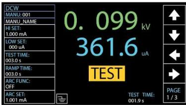
다양한 고전압 절연 제품의 생산 시험 및 특성 검증을 위해 GPT-15012는 제품 또는 부품에 대한 작은 누설 전류 측정을 실현하기 위해 최대 0.1µA의 전류 측정 해상도인 1V 단위로 조정할 수 있는 내전압 시험 전압(DC12kV)을 제공합니다. 또한 절연저항 시험전압을 50V~5000V의 직류출력 범위에서 50V단위로 조절할 수 있고, 저항 측정 분해능도 0.1MΩ에 달할 수 있습니다. 이러한 기능을 통해 사용자는 높은 정확도와 신뢰도로 다양한 안전성 시험과 검증을 수행할 수 있습니다.
