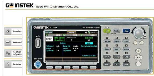
DAQ-9600은 RS-232C, LAN, USB 및 GPIB(옵션)을 제공하여 가장 적합하고 일반적인 원격 제어 인터페이스 요구사항을 충족합니다. 사용자는 무료 데이터 수집 소프트웨어(DAQ-Data Logger)를 통해 쉽고 빠르게 테스트를 설정하고, 측정 데이터를 획득 및 저장하며, 측정 프로세스 중에 실시간 관찰 및 분석을 수행할 수 있습니다.
